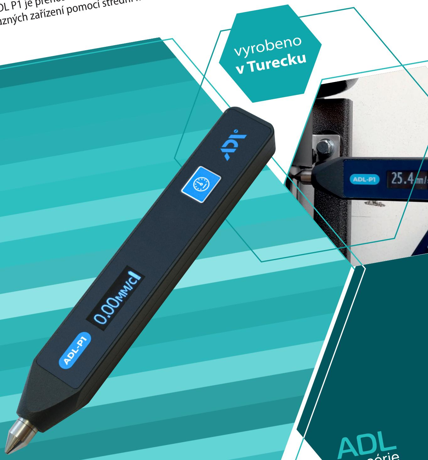
**ADL P1** je přenosné zařízení, které umožnuje provádět expresní diagnostiku stavu vibrací různých zařízení pomocí střední kvadratické hodnoty (RMS) rychlosti vibrací.
